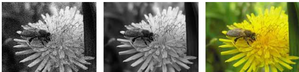
Мал. 8.3. Зображення з кодуванням 1 біт, 8 біт та 24 біти на піксель за однакової кількості пікселів
