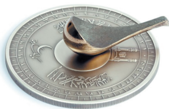
Мал. 43. Китайський компас у вигляді ківшика з магнетиту. Приблизно 2600 років до нашої ери
