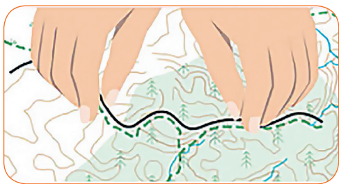
Мал. 97. Визначення довжини кривих ліній на карті
