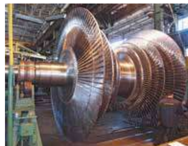
Мал. 6. Виготовлення турбіни на Харківському підприємстві «Турбоатом»
